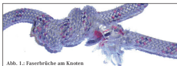
Abb. 1.: Faserbrüche am Knoten
