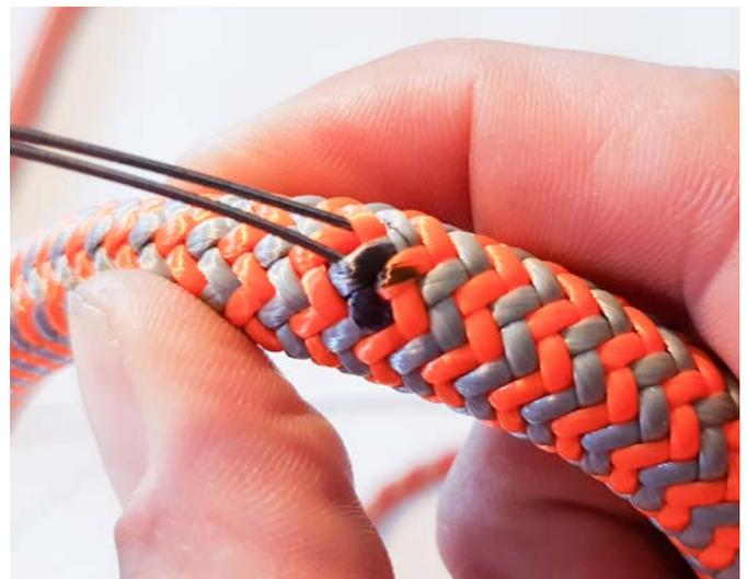
Spleißbahle/Spleißnadel (Draht) mit Schlinge am Ende
