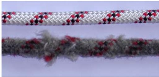
Abb.2: starker Seilabrieb, Abnutzung mit Seilverdickung
