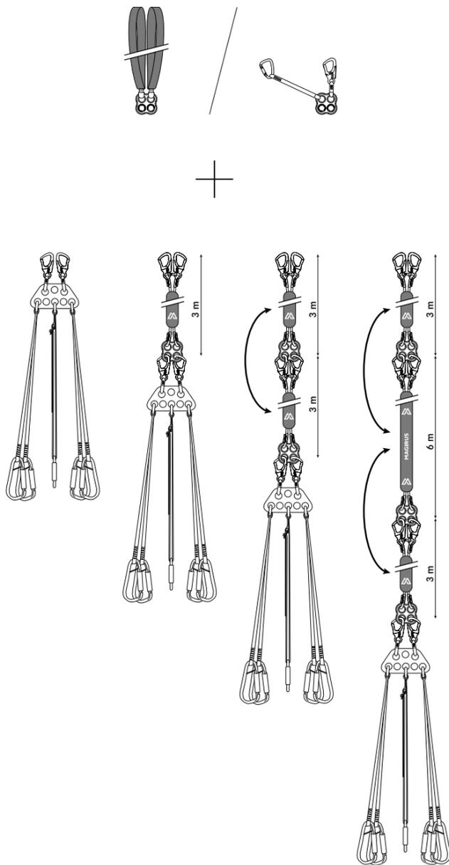
Einhängen an den Anschlagpunkten an der Leiterspitze und am MAGIRUS Safety Peak
